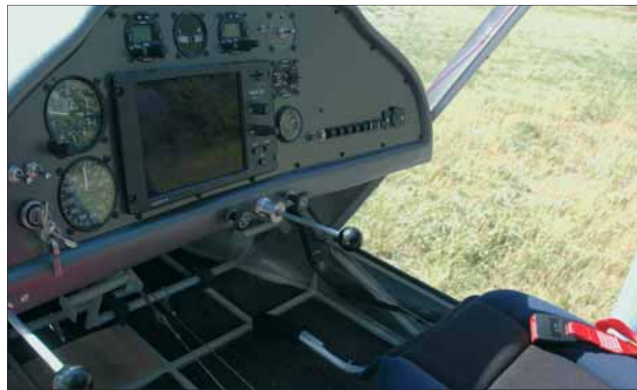
Après plusieurs essais, le design du tableau de bord est aujourd'hui figé. Il est largement proportionné pour accueillir, comme bon nombre d'ULM désormais, une avionique de type glass cockpit. Par ailleurs, tout le faisceau électrique est fabriqué par un sous-traitant de l'automobile.
